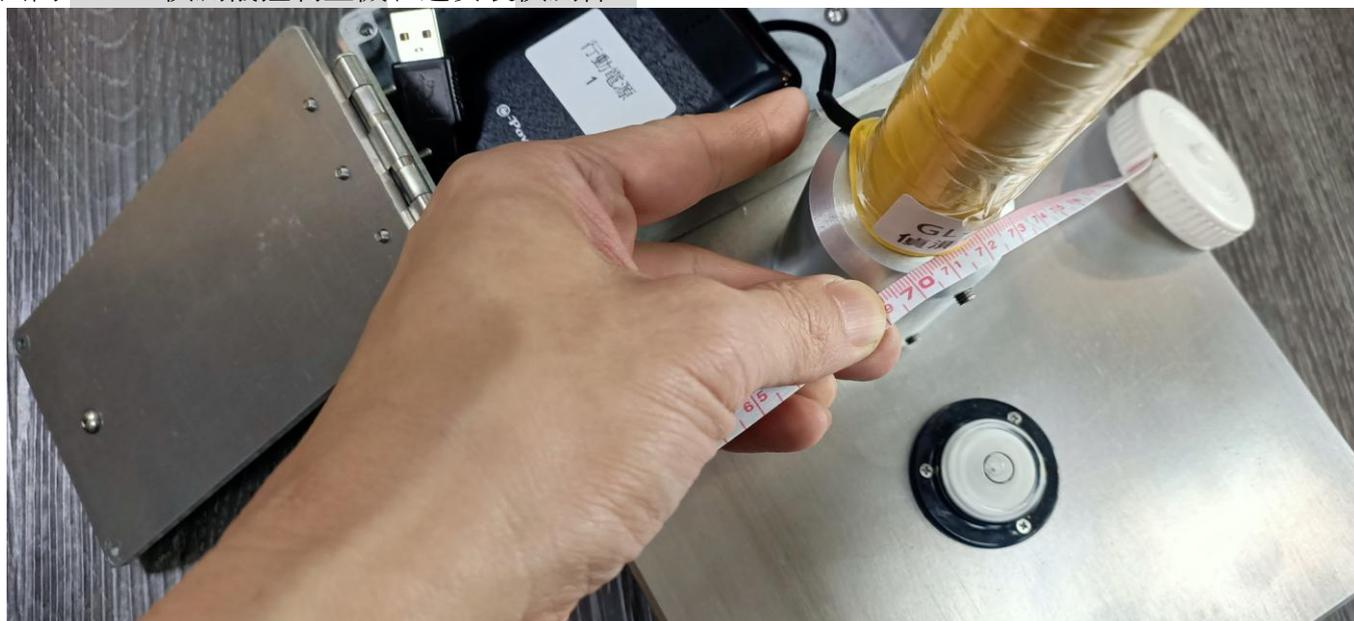
(6)面向 GL-i19 偵測儀控制主機左邊安裝偵測桿 2(含超聲波)。
