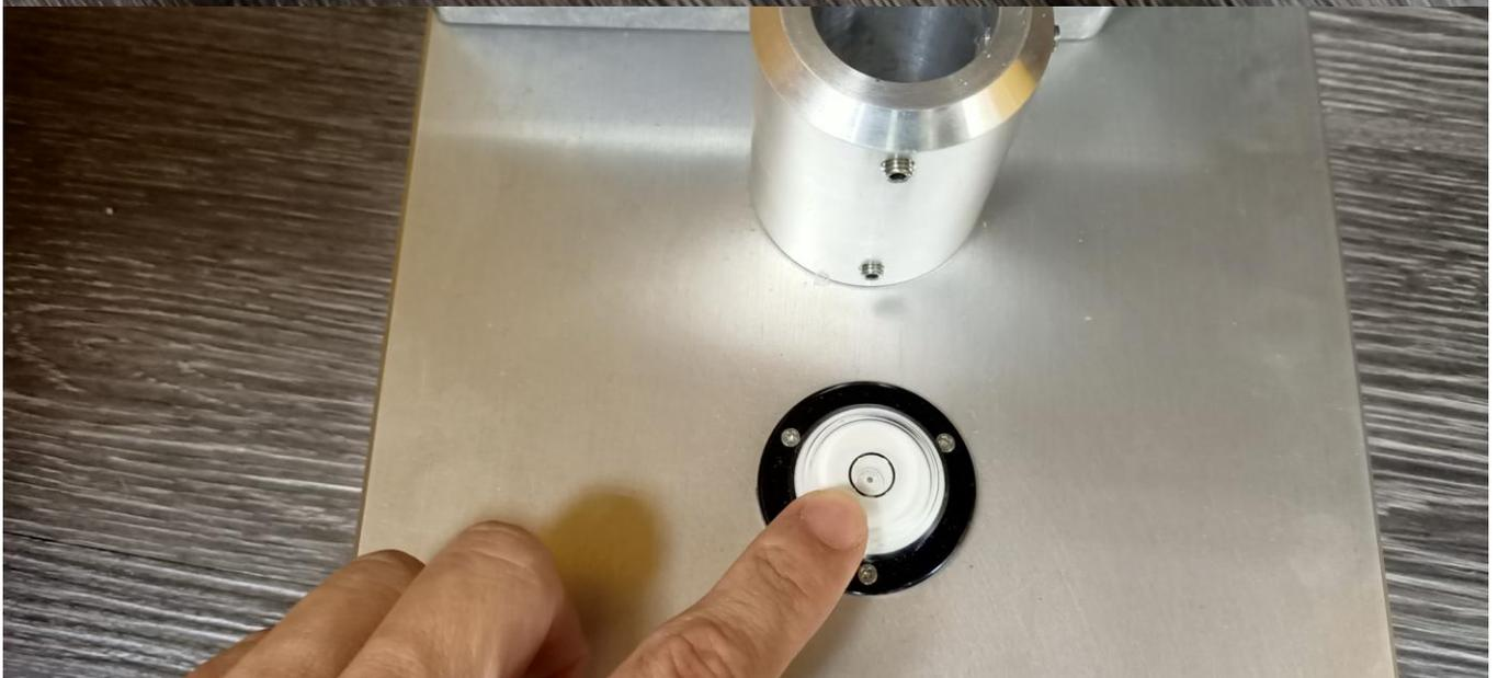
(4)以六角扳手鬆開偵測桿底座螺絲，偵測桿有 USB 電源線，可以直接接 USB DC5V 變壓器或行動電源，底座有電池盒，依偵測桿 USB 線位置對著盒上的線槽插入底座，再以六角扳手轉緊偵測桿底座。
