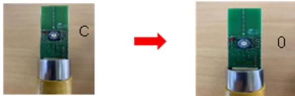
步驟 6. 偵測桿插上行動電源後，人員請迅速遠離偵測桿，以避免干擾到設備的校正，
