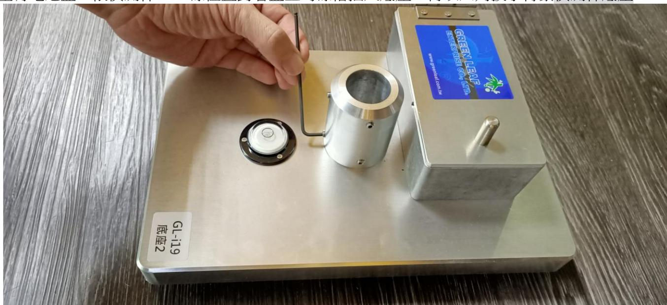
(5)面向 GL-i19 偵測儀控制主機右邊安裝偵測桿 1。
